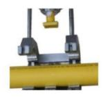
La silleta tiene el mismo principio del procedimiento a socket, pero se utiliza para derivación de redes, siempre se necesita un accesorio (Silleta) y las caras cóncavas y conexas para realizar el proceso de fundido.
