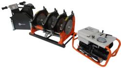
Es un método de soldadura simple, rápido y económico que se utiliza para unir tubería plástica principalmente de polietileno y polipropileno con o sin accesorios. Por medio de una plancha de calentamiento se aplica calor en la superficie de las zonas a soldar hasta alcanzar la temperatura de fusión del plástico, y se unen tras la aplicación de una presión, bien sea por procedimientos manuales o hidráulicos.
